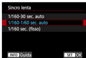
È possibile impostare la velocità di sincronizzazione del flash per la fotografia con flash in modalità **[P]** o **[Av]**. La velocità di sincronizzazione del flash massima varia in base alla combinazione di impostazioni per **[📷: Modalità otturatore]** e **[📷: Ritaglio/rapporto dimens.]**.
